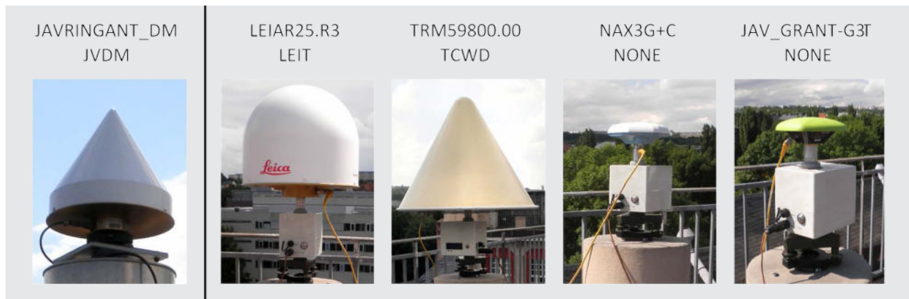
Abb. 3: Referenzantenne JAVRINGANT_DM JVDM und die vier Prüfantennen jeweils auf dem DRB2
